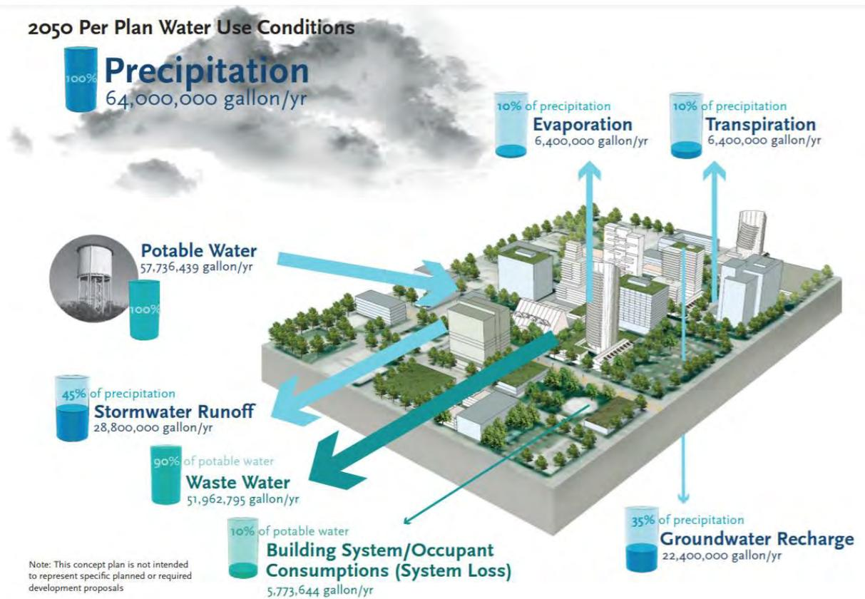
Figura 9: Sistema de monitoramento das águas em Lloyd Crossing (MITHUN DESIGN FIRM, 2020).
