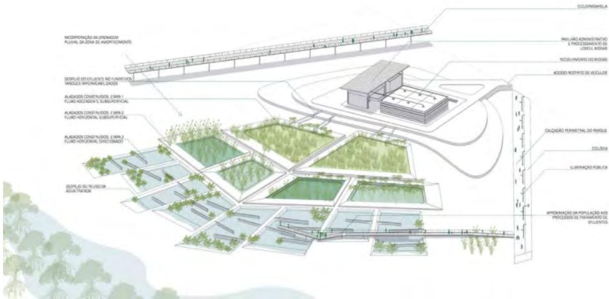
Figura 10: Sistema de tanques de tratamento de esgoto do Parque do Cocó (COTA 760, 2017).
